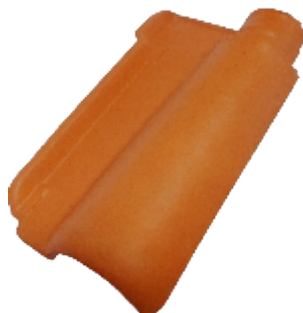
TELHA PORTUGUESA Peso: 2,400Kg Comp.: 39,6 cm Quant. p/ m2: 17,5 telhas
