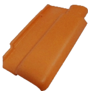
TELHA ROMANA Peso: 2,400Kg Comp.: 39,8 cm Quant. p/ m2: 17 telhas
